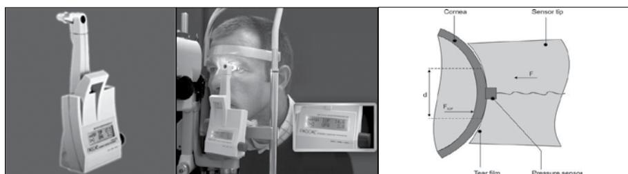
Slika 3. Paskalov dinamički tonometar
